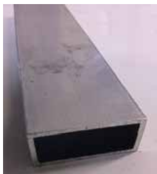
Slika 3: Aluminijasti profil 40 x 20 x 2,5 mm.
