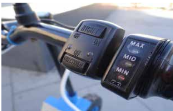
Slika 14: nadzorna plošča za stanje baterije in luči.
