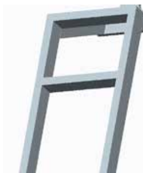
Slika 9: Primer uporabe središčnih povezovalnih profilov.
